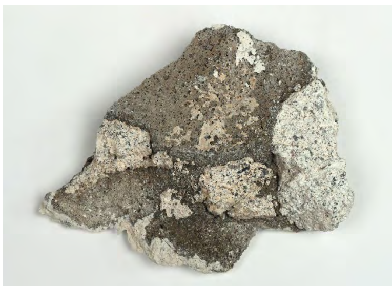
Fig. 31. Bak den harde sementpussen var det rester av to ulike typer kalkmørtel.
