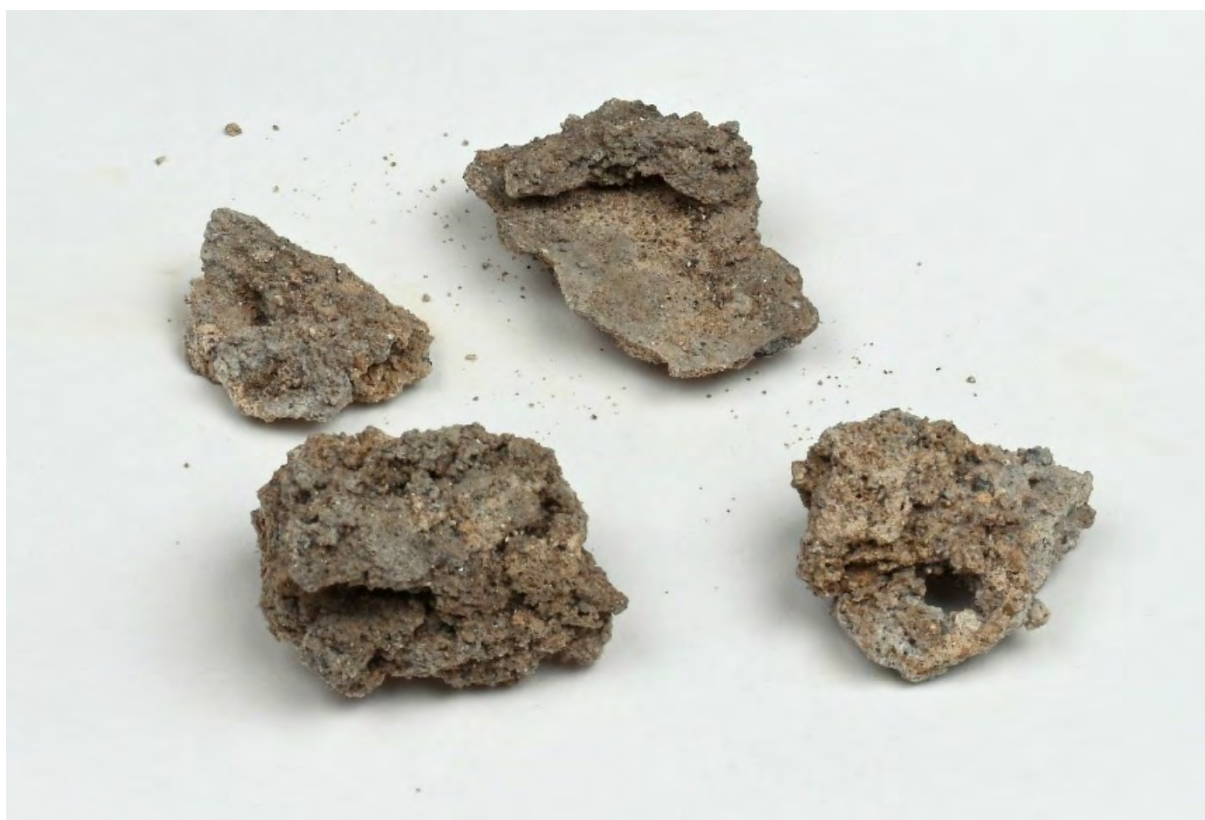
Fig. 17. Mørtelprøver, størrelse 2–4 cm. Prøvene ble tatt et stykke inn i veggen og kan være mørtel fra fuger som tilhører kirkens byggetid.
