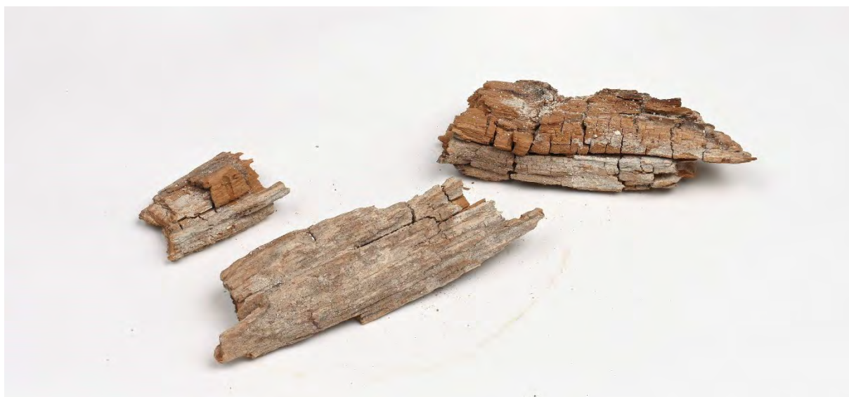
Fig. 41. Materialprøve. Sterkt råteskadet. Lengde: 3–8 cm.
