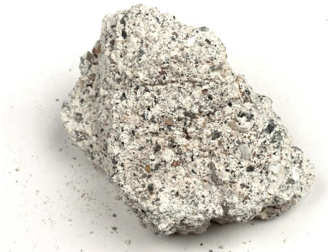
Fig. 28. Mørtelprøve fra skipets nordøstre hjørne, ved stillasstokk (prøve 5). Mål: 7 x 7 cm.
