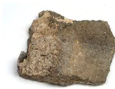
Fig. 20. Baksiden viser den harde sementholdige pussen som ble brukt i 1956. Baksiden har rester av eldre kalkmørtel.
