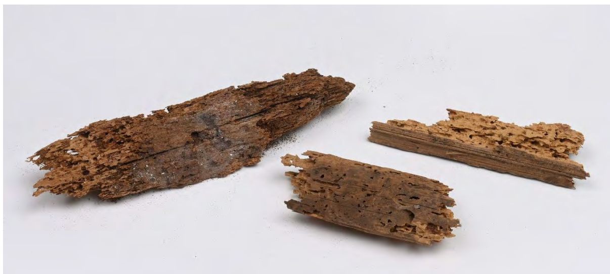
Fig. 26. Materialprøver av stillasstokk. Mål: 6–11 cm. Treverket er hardt angrepet av treborende insekter. Hullet i veggen var delvis dekket av sand fra sandblåsing.
