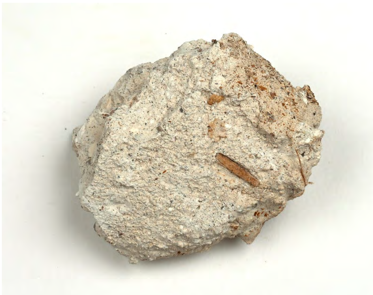
Fig. 38. Mørtelprøve med innblandet treverk. Innside mot muren. Mål: 9 x 4,5 cm.
