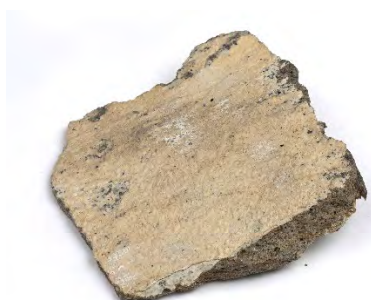
Fig. 19. Pussprøven måler 11 x 11 cm. Den er dekket med to lag mineralittmaling og et ytre lag med kalkhvitning som er nesten helt vasket bort.
