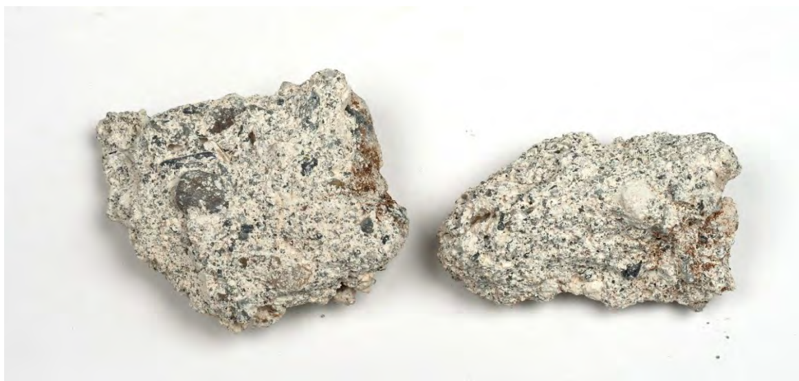
Fig. 45. Mørtelprøver ved stillasstokk. Mål 5–6 cm.
