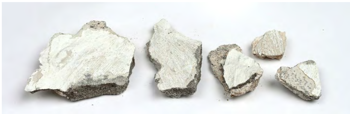
Fig. 29. Sementholdig hard puss med underliggende mineralittmaling og tynnere overliggende lag med kalkhvitting. Mål: 4–10 cm.
