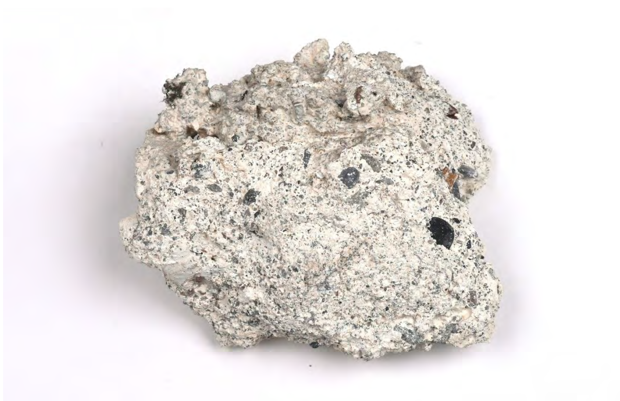
Fig. 33. Eldre mørtelprøve fra felt 7 (baksiden av fig. 32). Mål: 6x7 cm.
