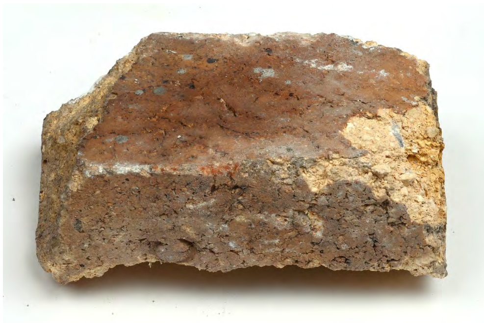
Fig. 39. En gul teglstein brukt som pinningsstein. Steienen er hardt brent. Mål: 10,5 x 6,3 x 4,0 cm.
