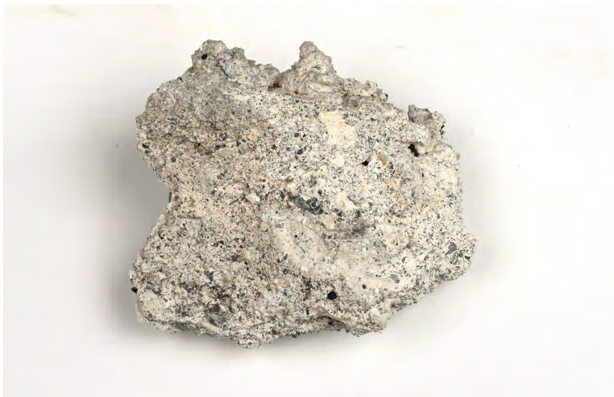
Fig. 32. Eldre mørtelprøve fra felt 7. Mål: 6x7 cm.
