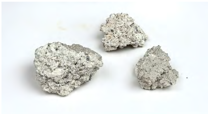
Fig. 27. Mørtelprøver fra skipets nordøstre hjørne, ved stillasstokk (prøve 5). Mål: 4–6 cm.
