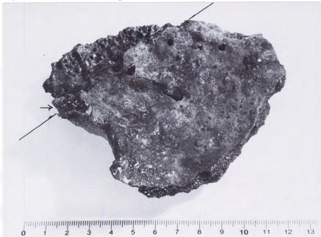
Fig. 83a. Grønn ovns- eller digelvegg. Slaggside med "slagglinje" avmerket. Prøvestykke med kobber-kule tatt ved pilen. (Possible tuyère (?) of burned and slagged clay. C.McL.)
