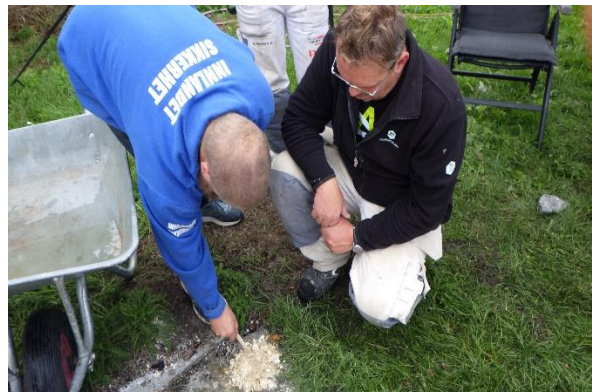
Tore Granmo og Erik Bjørnstad tester og tester og tester kalken. Og ja, den er gjennombrent etter bare 26 timer.
