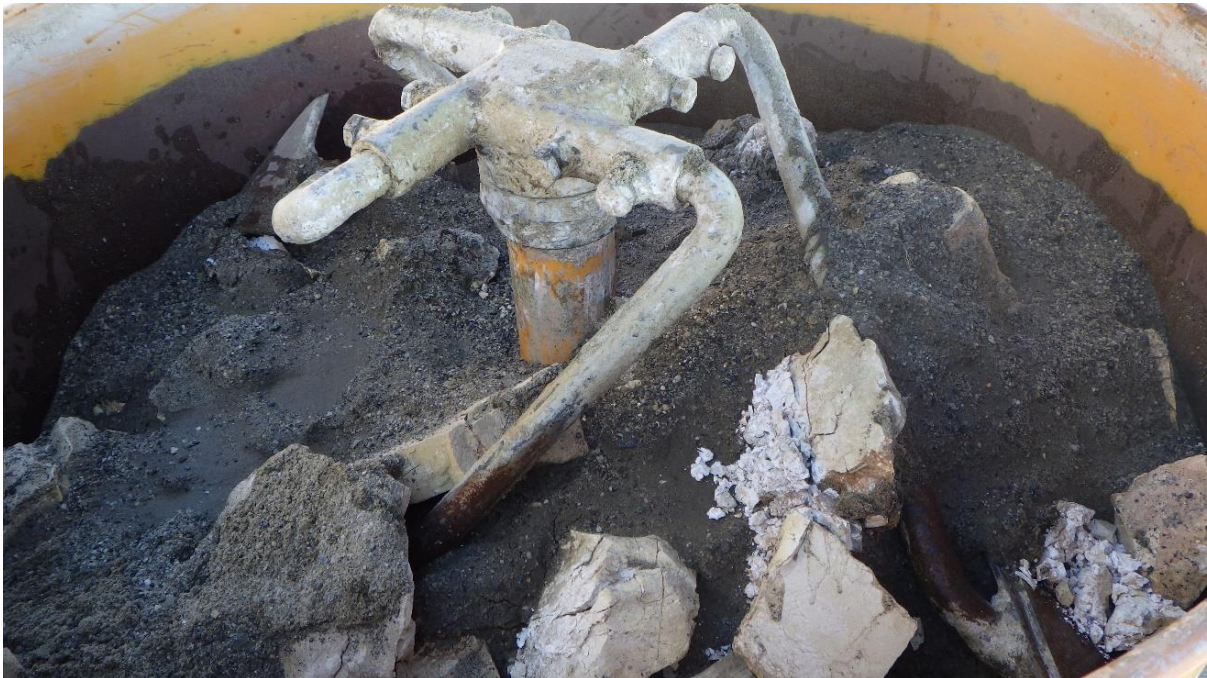
Kalken leskes direkte i tvangsblenderen. Mørtelen brukes varm.
