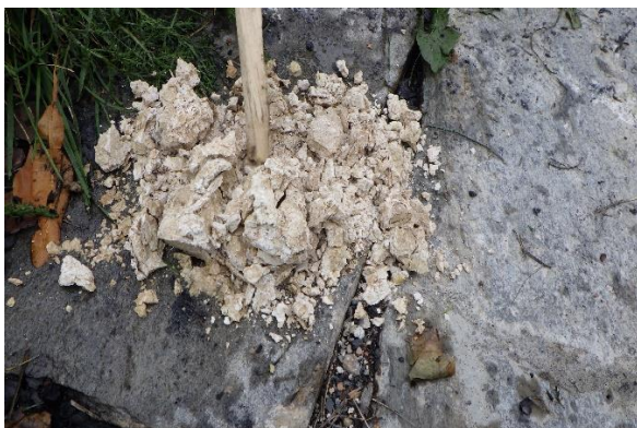
Tore Granmo og Erik Bjørnstad tester og tester og tester kalken. Og ja, den er gjennombrent etter bare 26 timer.
