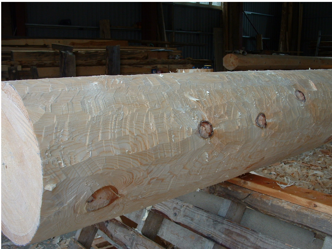
Stavkyrkjeprogrammet: Ferdig hogd stav klar for skaving. Foto: Erlend Gjelsvik, Riksantikvarens arkiv.
