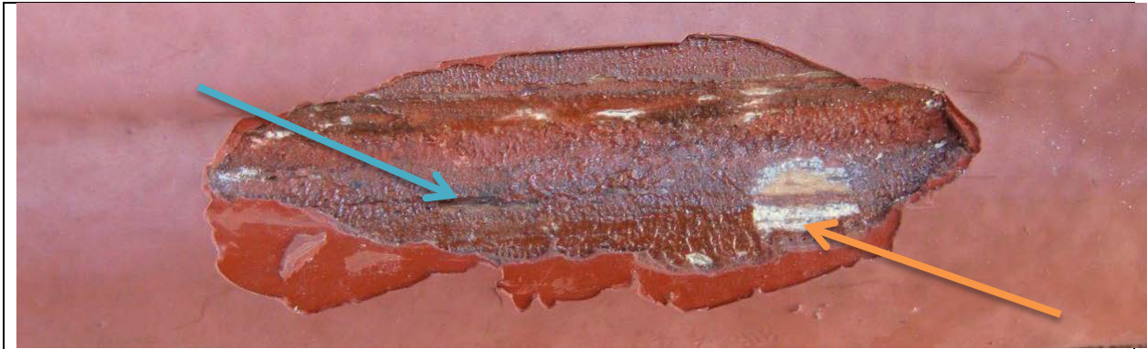
Foto viser en avskrapning gjennom fargelagene i en linoljebære i malingen. Den orange pilen viser de lyse, tidligste fargelagene (nr. 1 og 2 i tabellen over). Den blå pilen viser det første, røde oljerike laget (nr. 3 i tabellen over).
