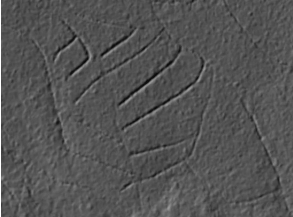
Figur 21. Et eksempel på hvor viktig retningen og vinkelen på det kunstige lyset er for muligheten for å identifisere strukturer i terrenget. De to utsnittene er identiske og viser et område med grøfter i myr. På øverste figur kommer lyset fra nordøst, på det nederste fra nordvest. Illustrasjon: NIKU.
