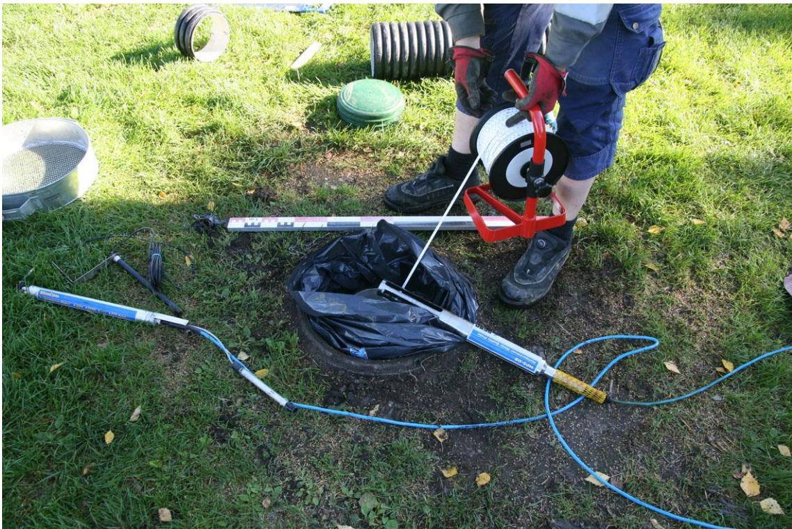
Figur 7: Nye multisensorer ved BP14 før etablering i brønnrøret (Foto: niku_ark_310042).
