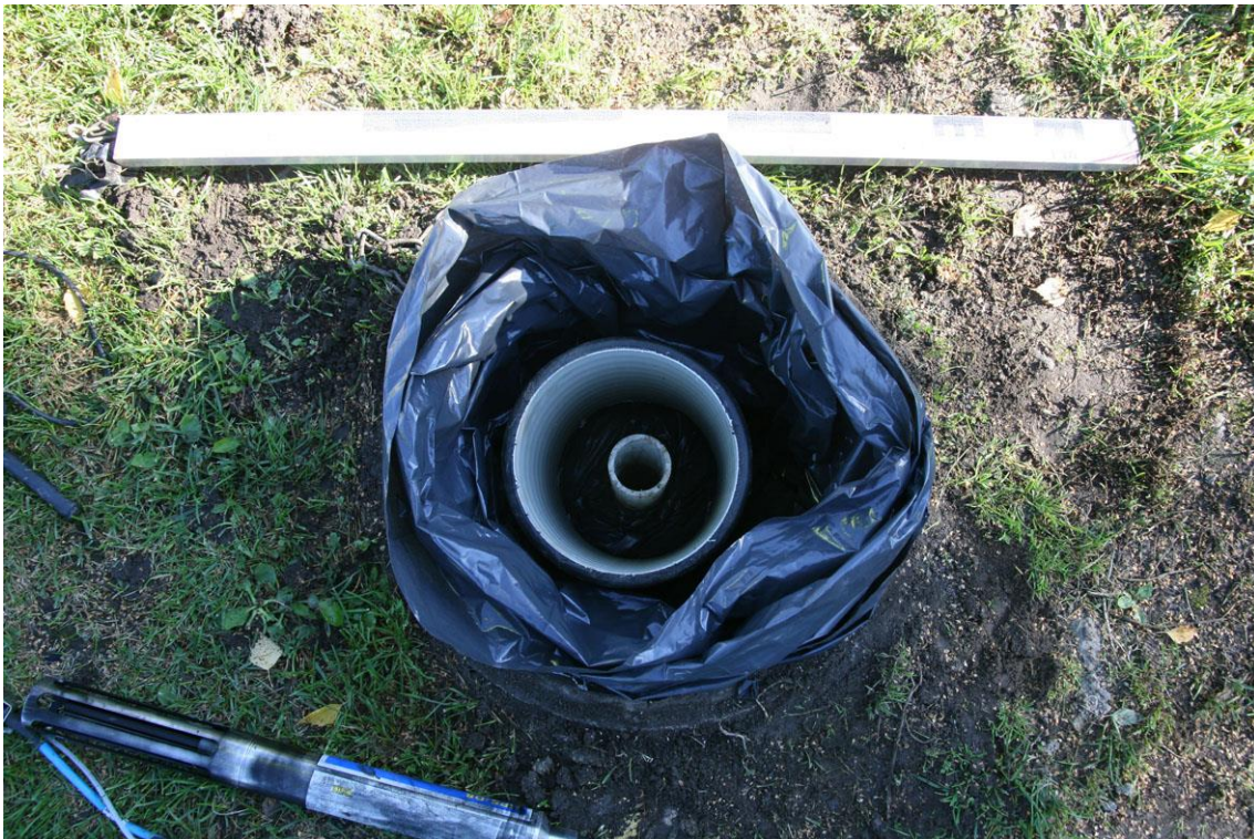
Figur 13: Tiltak for å forhindre vanninnslag og drukning av loggeren.
