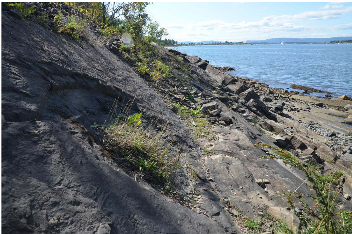
Figur 49: Brudd 1, vestre del. Relativt moderne steinbrytning ved at man har boret et kort hull og sprengt løs plater, slik at det står igjen et grunt "eksplosjonshull".
