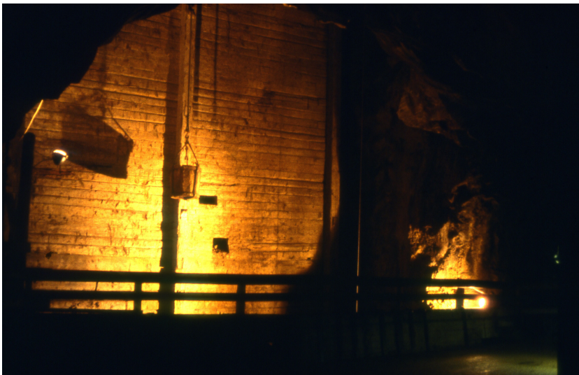
Fra besøksgruva i Falun, tømmervegg og heisetønne i den 208 m dype "Creutzschakt". (Foto: B. I. Berg 1978)
