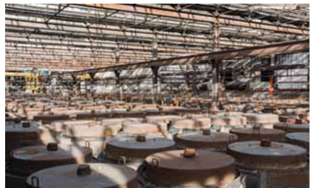
Interiør fra bygg. 106 der 325 Franc Caro ovner står. Renovering av taket har begynt.
