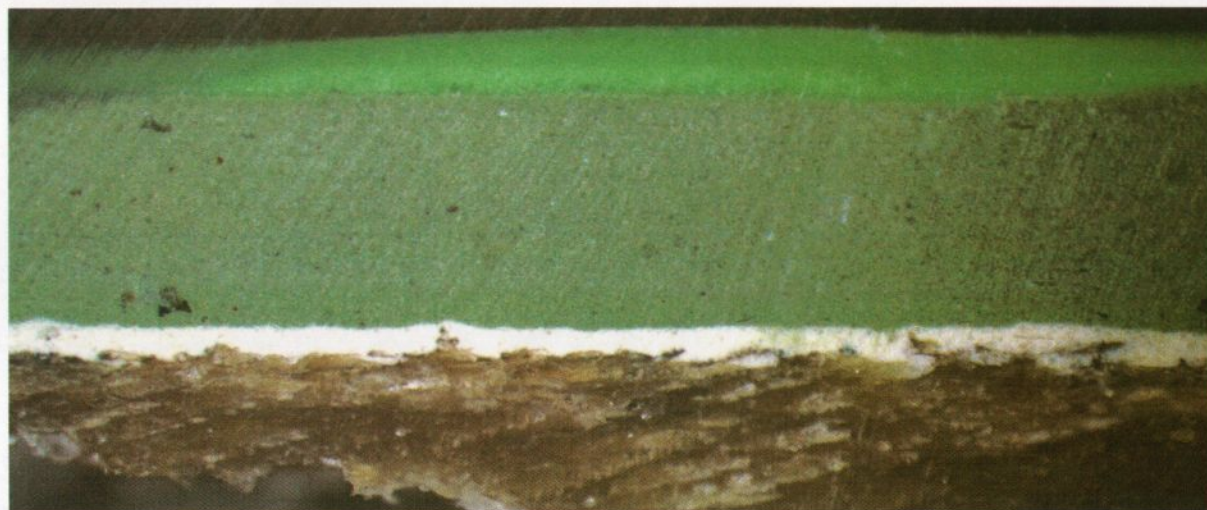
Figur 6. Fargesnitt som viser alle fargelagene på nord og vestveggen. Treverket nederst, følges av det hvite fargelaget. Over dette kan så vidt skimtes det eldste grønne fargelaget. Deretter følger det tykke, grønne fargelaget fra 1985. Det er liten forskjell mellom det eldste grønne fargelaget og 1985 fargelaget. Øverst ser vi malingslaget som ble påført i juli 2006. Det er lett å se at dette malingslaget både i farge og tekstur, i vesentlig grad skiller seg fra de to eldre fargelagene. Foto. Jon Brænne, september 2006.
