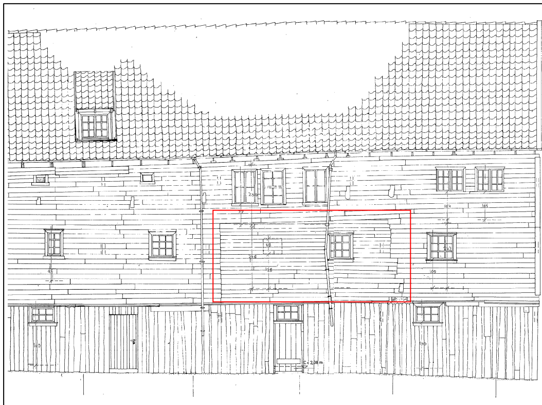
Nordfasaden av Bredsgården i C. Panelbordene innenfor den røde markeringen er sekundære. Tegning: Laila Nilsen 1979
