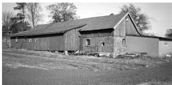
130-0309-002. Sveitserlåve i det "bynære området". Låvedelen skal være eldst, fra 1860-tallet, fjøs og stall er yngre. Siden registrering er den blitt pusset opp og utvidet noe, utbygget er forlenget og dekker nå også teglfjøset. Teglsteinen på taket er dels skiftet ut med plater, og vinduene er skiftet. Endringene er klassifisert som endringstype B. Siden SEFRAK-registrering er omgivelsene fortettet med bolighus.
