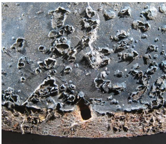
Fig 7 og 8: Løs maling og oppskallinger ble fjernet med skalpell. Også bulker med maling ble punktert, slik at man kunne komme til korrosjonen. De løse bitene ble deretter børstet bort med myk børste. Det som måtte være igjen av rester ble fjernet under overflaterens. Detalj fra Begravelseskjold-sør.
