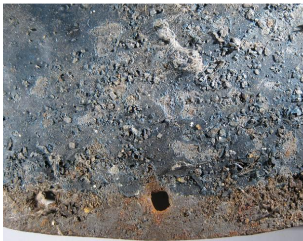
Fig 7 og 8: Løs maling og oppskallinger ble fjernet med skalpell. Også bulker med maling ble punktert, slik at man kunne komme til korrosjonen. De løse bitene ble deretter børstet bort med myk børste. Det som måtte være igjen av rester ble fjernet under overflaterens. Detalj fra Begravelseskjold-sør.
