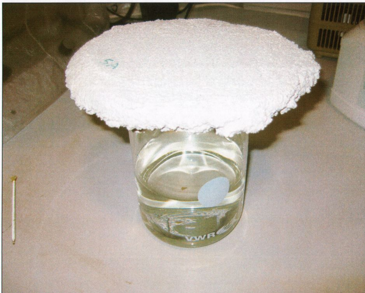
Bilde 1, Damppermeabilitetsprøve 5A, Foto: Annika Haugen
