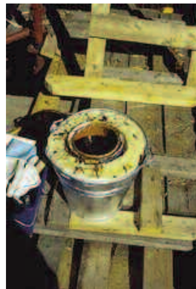
For at tjæren skal holde seg varm, er tjærespannet satt ned i en bølge isolert med polyuretanskum.
