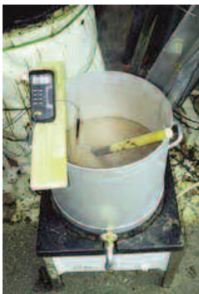
Koking av tjære. Kraftig skumming under koking tyder på at tjæren kommer fra en tidlig tjærefraksjon i mila.
