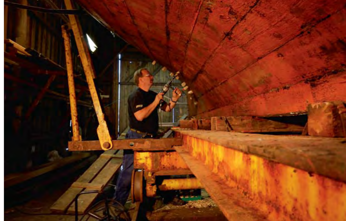
Bragdøya trebåtverksted: Trebåtbygger Håkon Danielsen flikker på den gamle rekefølgeren «Pil».
