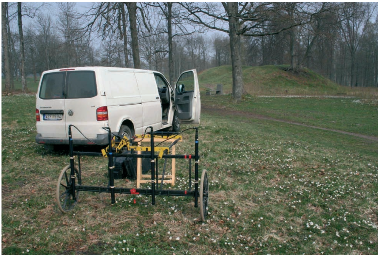
Magnetometer i bruk på Borre, Horten kommune, Vestfold sommeren 2008. Fire målestaver ble trukket for hånd over gravfeltet. Ved hjelp av magnetometer og georadar ble det påvist to store hall-bygninger i tilknytning til gravhaugene. Foto: Knut Paasche, NIKU.
