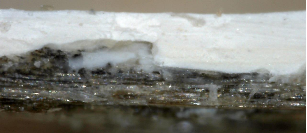
Figur 26. Lunde kirke. Macrofoto av malinglagene på sørveggen. Nederst er treverket. Over dette sees rester av eldre hvite malinglag, med mye spor av svertesopp. Over dette sees to tykke lag med akrylmaling. 60 x. Foto: J. Brønne 14.11.2022.
