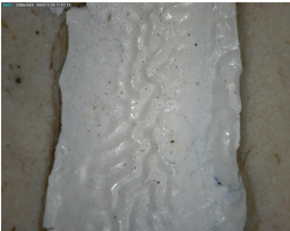
Figur 33. Lunde kirke. Macrofoto av eldste malinglag på laftekasse nordvestveggen. Prøven har karakteristiske tørkerynker fra linoljemaling som er påført for tykt. Dette viser at det eldste malinglaget på dette bygningselementet er en linoljemaling. 160 x. Foto: J. Brønne 14.11.2022.
