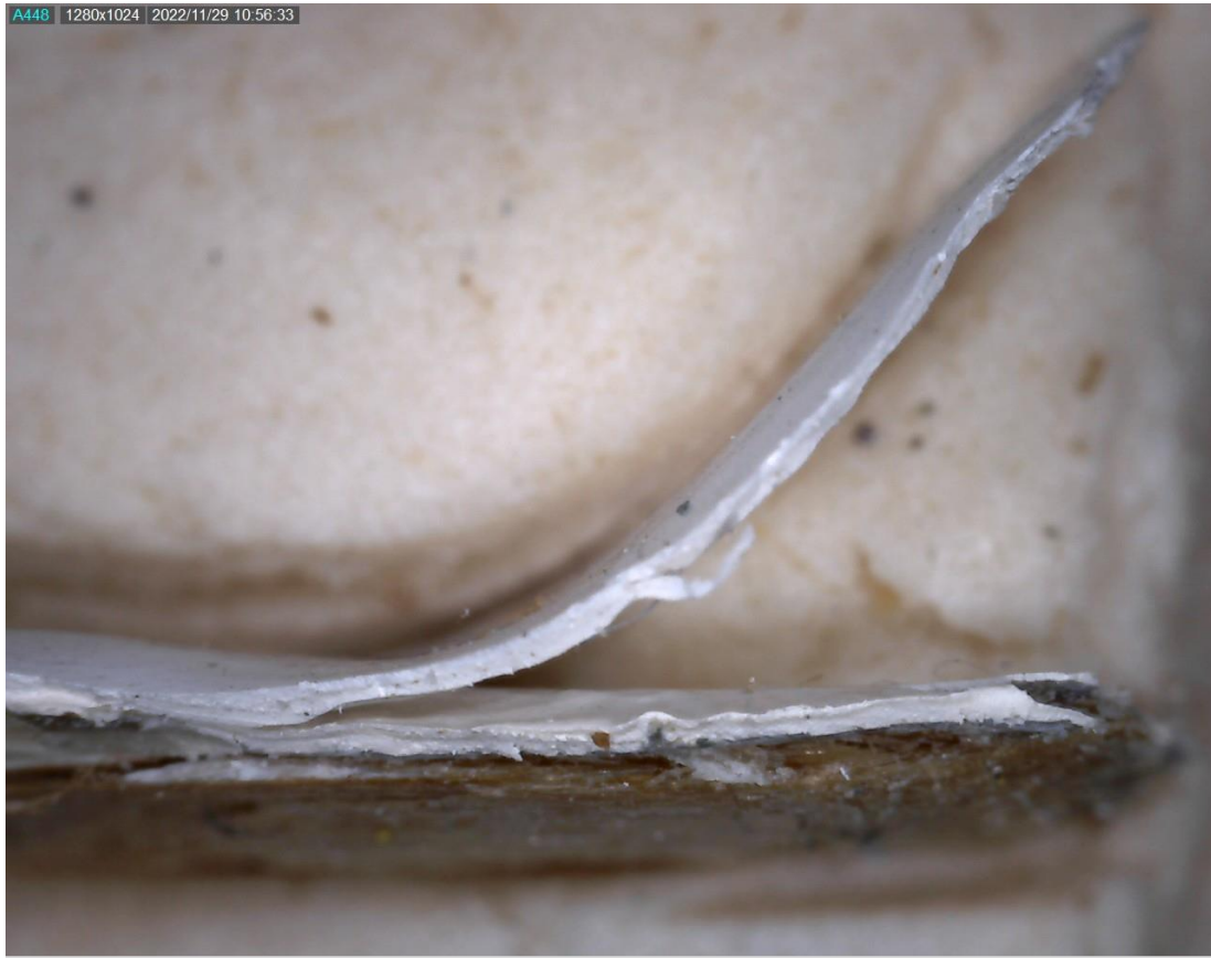
Figur 31. Lunde kirke. Macrofoto av treverk, eldre og ny maling på sørveggen. Treverket er nederst. Over dette flere lag med eldre, hvit maling. Deretter to lag med akrylmaling. Det er svært dårlig heft mellom de to akryllagene, slik at disse malinglagene deler seg. 60 x. Foto: J. Brønne 14.11.2022.
