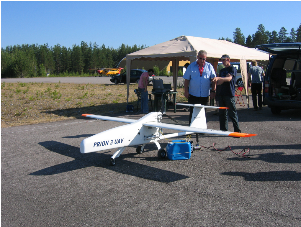
Figur 10 Det fjernstyrte ubemannede flyet som er utviklet av TGS Nopec. Slike fly kalles også UAV (Unmanned Aerial Vehicle) eller drone. Foto: Ole Risbøl, NIKU
