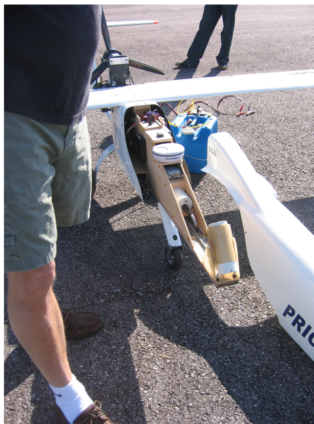
Figur 11 Magnetometersensoren montert på UAVen (den skråstilte sylindere) sammen med GPS-mottakeren (den runde hvite). Foto: Ole Risbøl, NIKU
