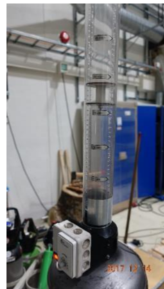
Figur 6: Utstyr for måling av lekkasjerate
