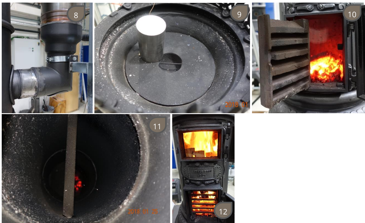
Figur 13: Detaljer ved oppsett og testing av sylindervovn
