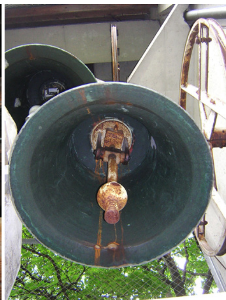
Ill. 15: Torshov kirke, Oslo. Klokke med balansekolbe. Balansekolben er monteret i en aksel, slik at den anslår øvre slagsted selv om klokken er monteret i vinkelaksel. FOTO: TERJE DE GROOT.
