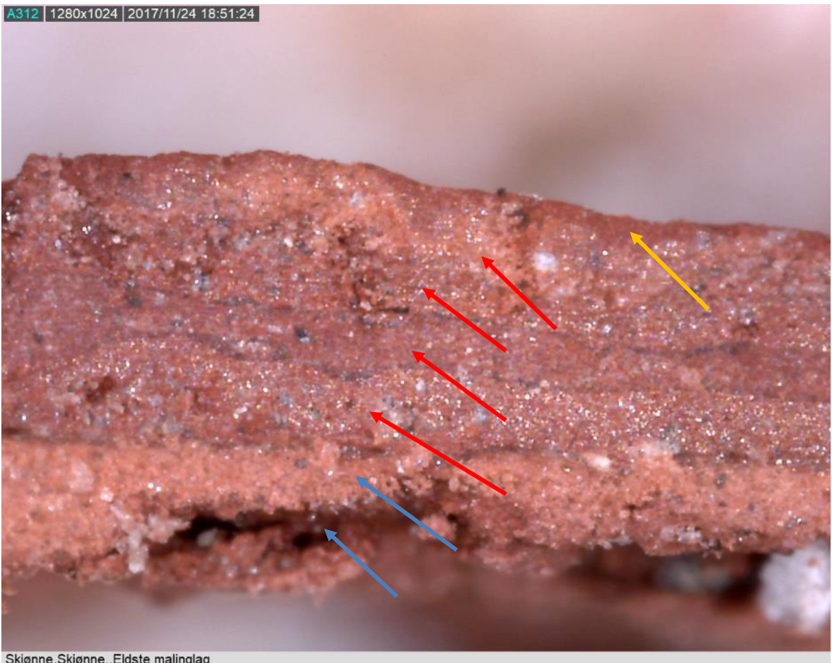
Figur 8. Skjønne, Søre. Fargesnitt av malinglagene på sydveggen. Seks malinglag er registrert. De to eldste er basert på emulsjoner (Blå piler), de øvrige på tørrende oljer, trolig linolje (Røde piler) og alkydoljer. (Gul pil) Foto. J. Brønne. November 2017.
