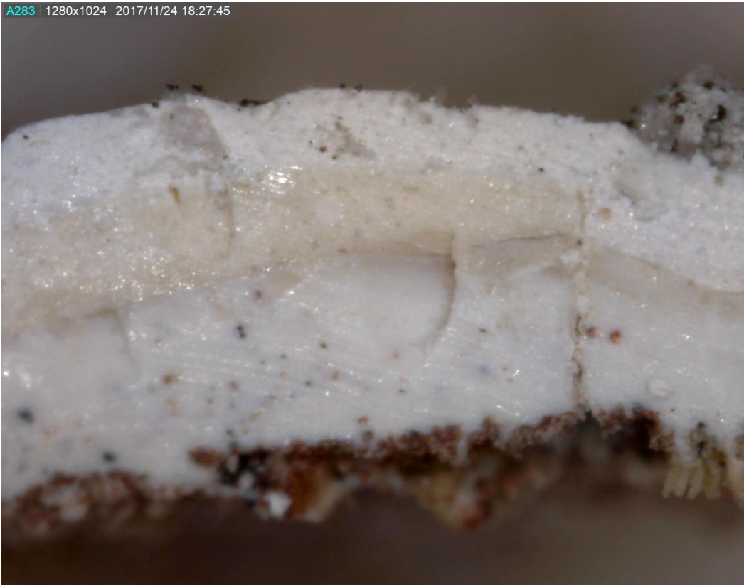
Figur 17. Skjønne, Søre. Fargesnitt av nordre løve på døromrammingen. Kun hvite malinglag. Nederste lag har spor av rødt. Trolig er dette søl fra et av de røde malinglagene på omliggende bygningsdeler, idet det ikke er funnet spor av rødt andre steder på de utskårede detaljene i fasaden. Foto. J. Brønne. September 2017.
