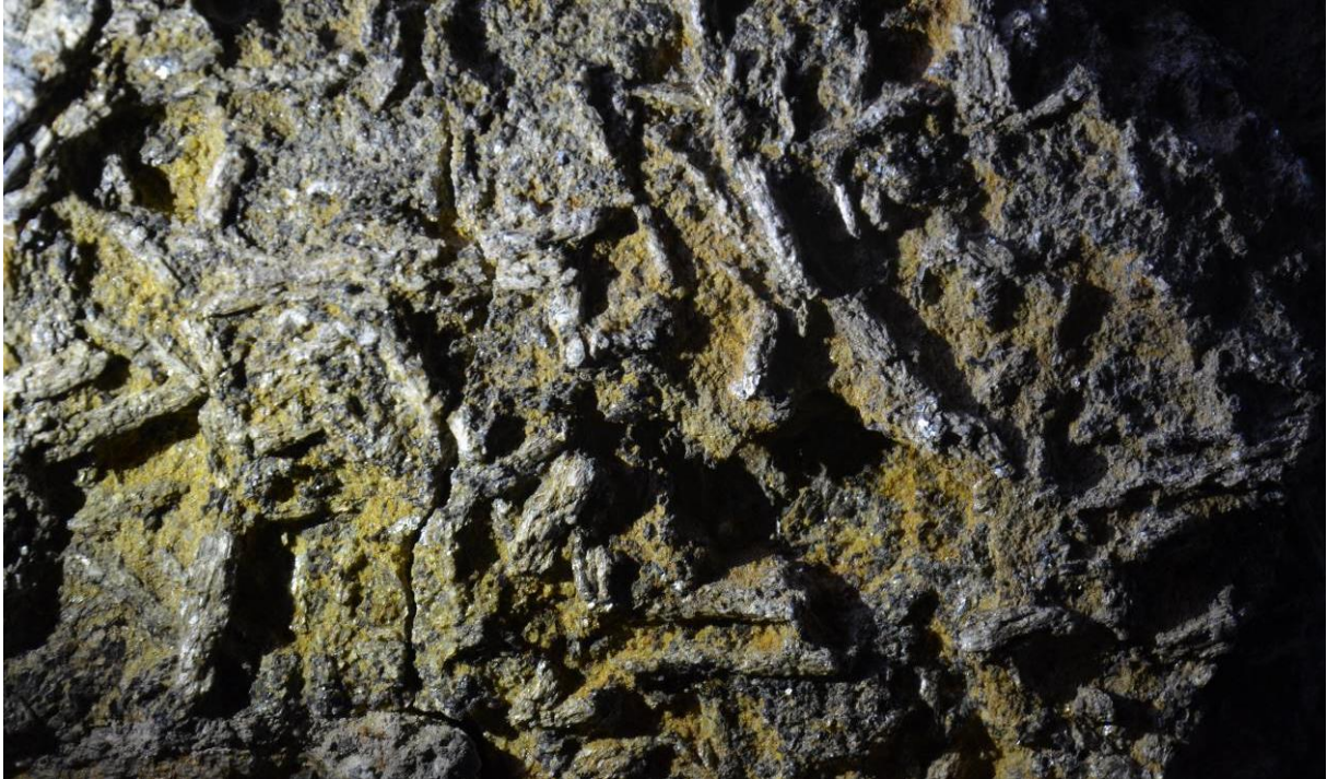
Figur 22: Forvitring av olivinstein, eller rettere: metaolivinstein (metamorf olivinstein). Vi ser et mønster av «nåler». Disse nålene består av mineralet talk, som er motstandsdyktig overfor forvitring. Den gullige grunnmassen består stort sett av mineralet olivin og dets forvitningsprodukt iddingsitt. Olivin er altså mye mindre motstandsdyktig enn talk. Se Storemyr (2010) for videre diskusjon.
