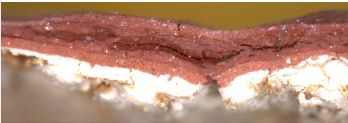
Figur 2. Røros. Flanderborg 5. Fargesnitt av malinglagene på panelet, fotografert i digitalt mikroskop. Nederst sees rester av treverket og det hvite malinglaget. Over dette sees de åtte lagene med rød jernoksid grunning- og malinglag. 260 x forstørret. Foto: J. Brønne. 9.10.2016.
