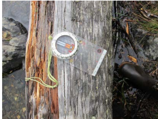
Foto 2. En ensidig råteskade i en gjennomvåt stokk på Røros kan være vanskelig å forklare inntil man ser sammenhengen med soleksponering.
