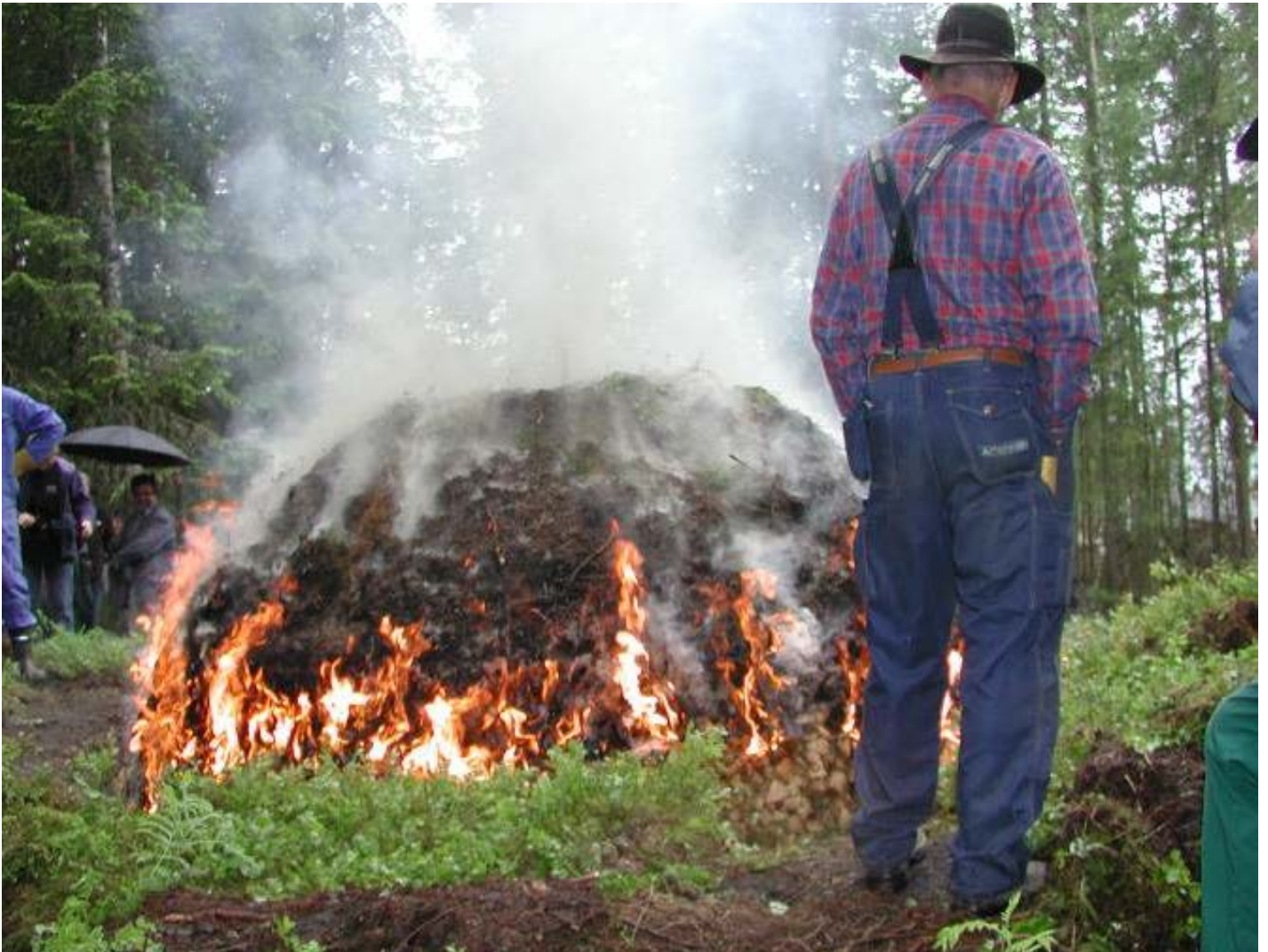
Tjærebrenning: Oppbygging av tjæremile med never og tyrived. Mila dekkast med torv før den vert kveikt. Foto: Kjell Marius Mathisen, Maihaugen
