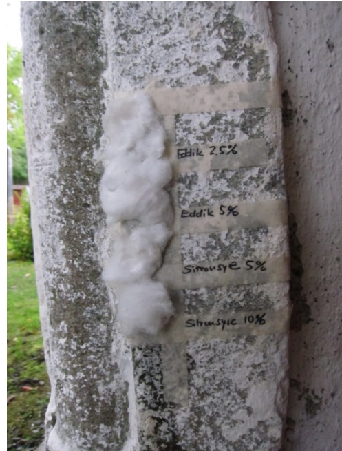
Figur 9: Løslighetstester med ulike syre vandige løsninger på portalens søndre side. Bomulldotter er lagt på avgrensede felt. Foto: NIKU 2016
