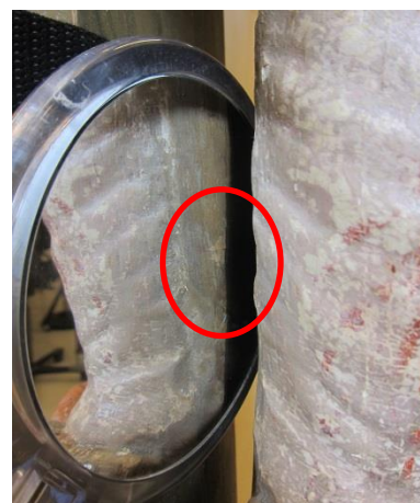
Foto 5: Treprøve tatt fra baksiden av skulpturen. Her sees baksiden ved bruk av speil for å se uttaksområdet fordi det ellers er vanskelig å komme til.
