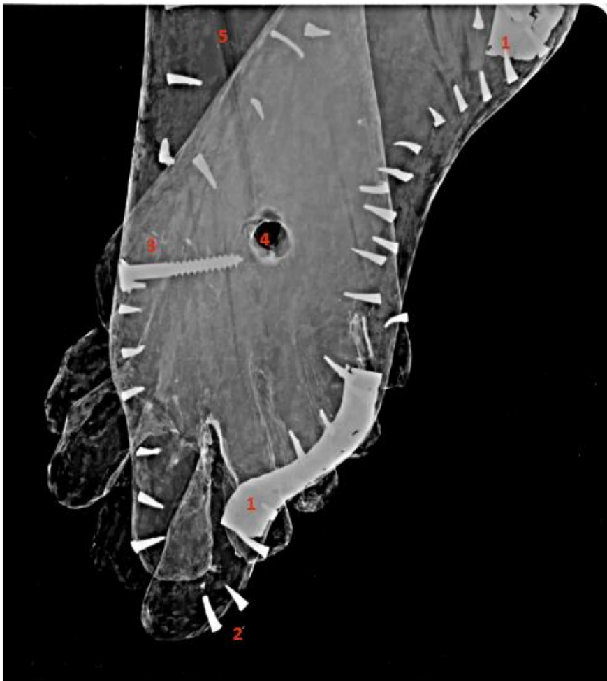
Figur 8 Røntgenbilde 3, føttene sett fra forsiden. Metallbeslag med hull etter søm (1), stifter (2), moderne skrue (3), hull (4), sprekker (5).
