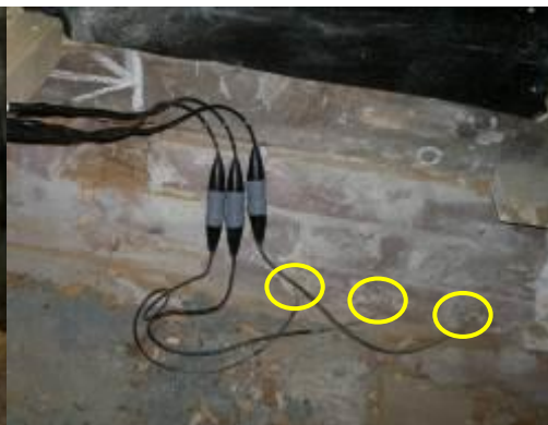
Figur 2. Sensorer for temperatur og relativ luftfuktighet i teglveggen. Sensorene er boret inn til tre ulike dybder.
