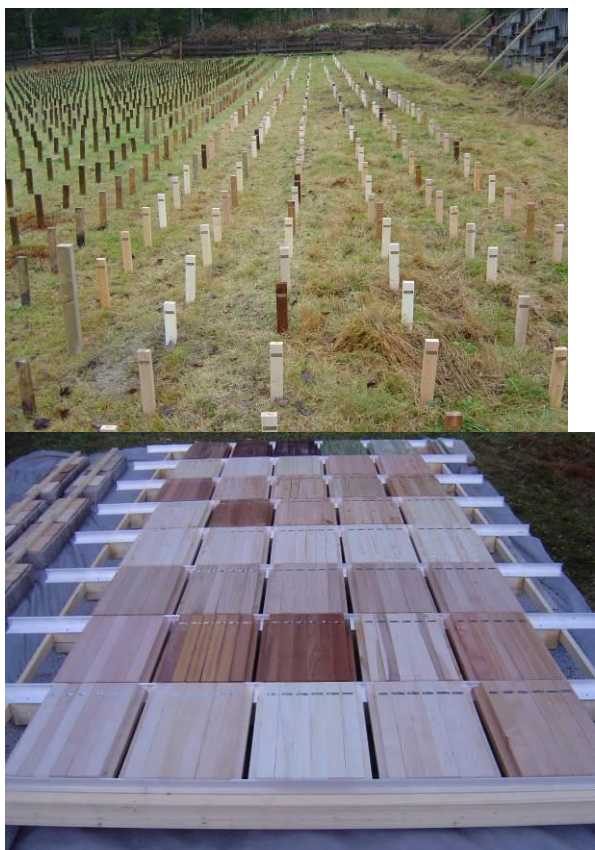
Figur 1. Felttesting i jordkontakt (NS-EN 252) og over bakken (Double Layer Test)
