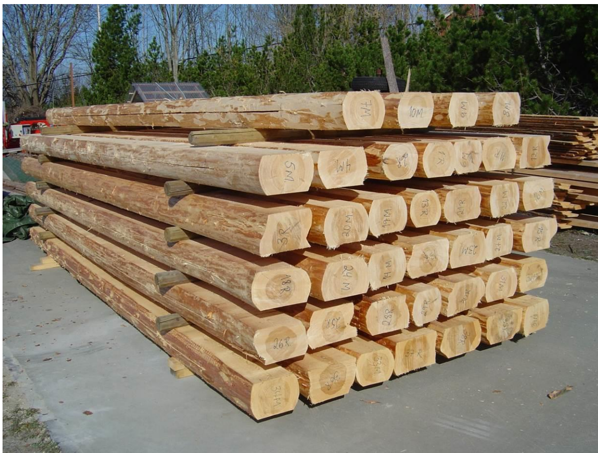
Figur 6. Lafteplank av furu med ulike typer sagsnitt for å redusere sprekkdannelser i sideflatene.
