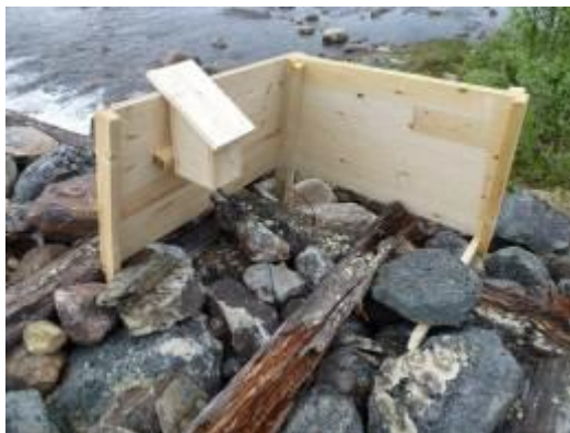
Figur 1. Plassering av loggere sommeren 2012: En logger utenfor solskjermen, og en innenfor. Skjermen er satt slik at den skjærer mot det aller meste av solinnstrålingen, men ikke mot nedbør.
