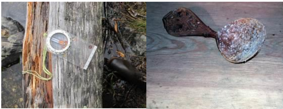
Figur 16. Lokale forhold (mikroklima) har svært stor betydning for utvikling av biologiske skader. Vanligvis vil fuktforhold i treverket være styrende for om det oppstår råteskader. I tilfeller der alt tømmeret er fuktig kan imidlertid temperaturen bli utslagsgivende, slik at omfanget av råteskader er avhengig av solinnstråling (foto til venstre). Omfanget av muggsopp-skader kan avgjøres av små forskjeller i næringstilgang, selv med helt like fukt- og temperaturforhold (foto til høyre).
