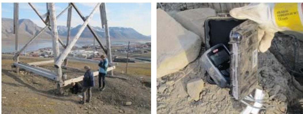
Figur 3. Langtidslogging av temperatur ved en taubanebukk i Longyearbyen
