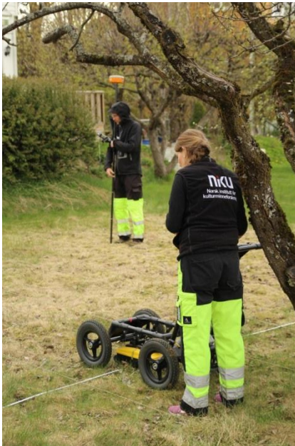
Figur 1: Enkeltkanals georadarsystem kjøres innenfor lokalt rutenett lagt ut på bakken. I bakgrunnen anvendes en RTK GPS for innmåling av undersøkelsesområdet. Foto: IH/NIKU.
