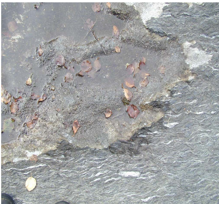
Figur 57. Sårkanter med aktiv forvitring som er blitt forseglet med sementmørtel. Åmøy, Rogaland. Foto: AmS
