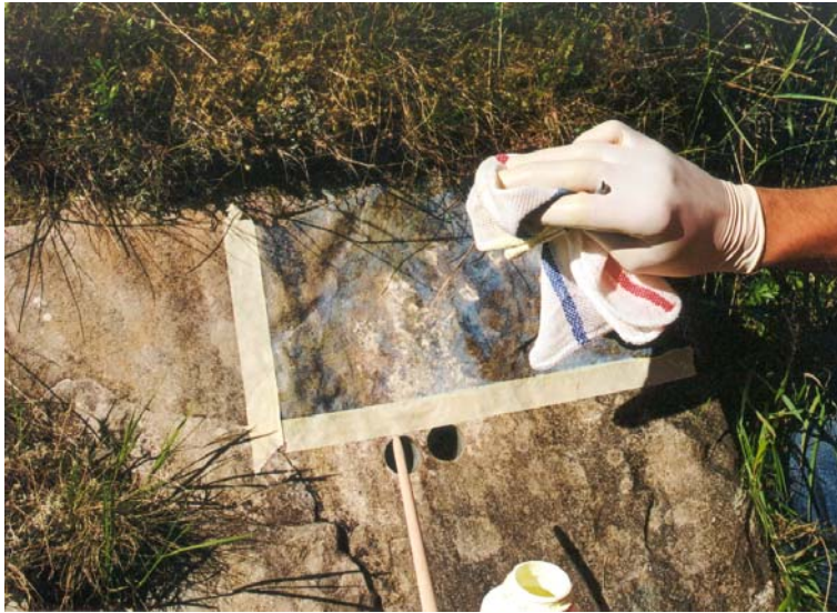
Figur 56. Test av ulike konsolideringsmiddel på sandsteinen i Vingen, Bremanger, Sogn og Fjordane. Foto: L. Sæbø.
