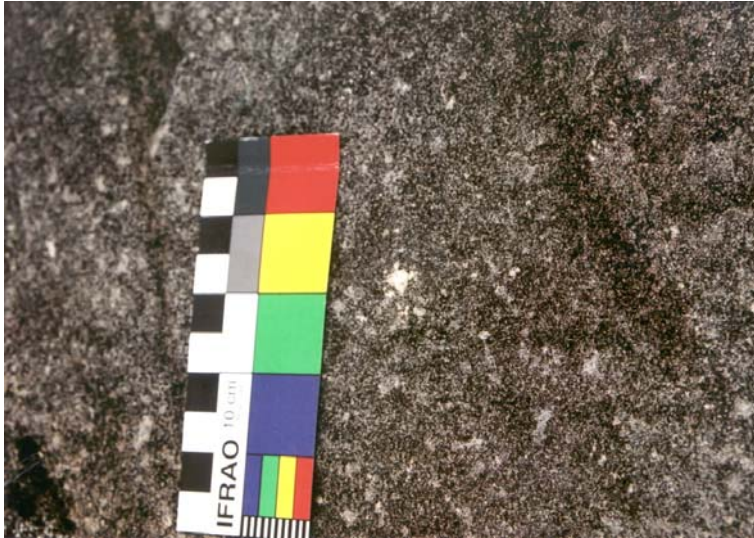
Figur 13. A) Grusforvitring er ofte synlig i form av små lyse prikker, der ny bergflate uten mikrovegetasjon/overflatebelegg er eksponert etter at sandkorn har spaltet av. Her fra Vingen, Bremanger, Sogn og Fjordane. Foto: L. Sæbø.
