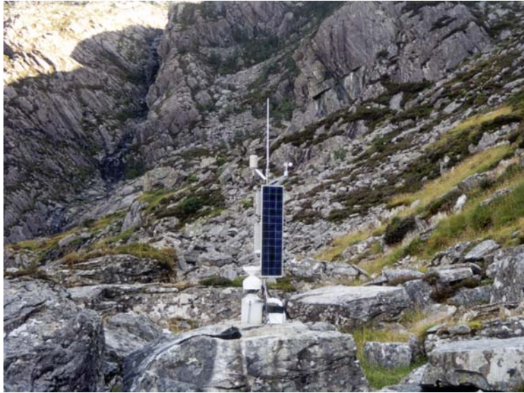
Figur 64. En automatisk klimastasjon kan måle lufttemperatur, luftfuktighet, vind og mengde nedbør. Bildet er fra Vingen, Bremanger, Sogn og Fjordane. Foto: I. H. Thorseth.
