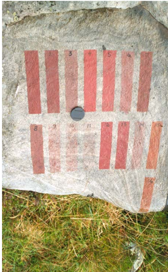
Figur 62. Prøveflate for test av ulike malingsprøver på granittoid gneis i Leirvåg, Askvoll, Sogn og Fjordane. A) et år etter oppstart (2003);
