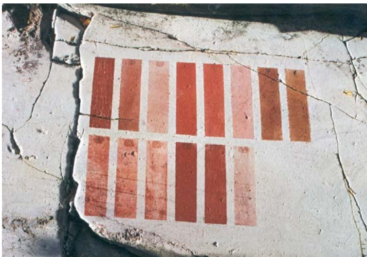
Figur 61. Fotografi av forsøksfelt for test av ulike malingsprøver i Hjemmeluft/Jiebmaluokta, Alta, Finnmark. Foto: L. Sæbø.
