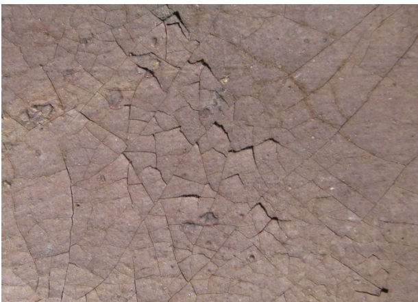
Foto 4: Detalj av skålformede oppskallinger og løs maling. Området er rett over Jesus' venstre hånd.
