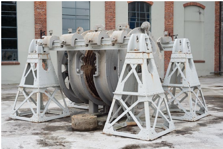
Den bevarte lysbueovnen på Notodden, plassert foran Ovnshus A. Foto: Per Berntsen. Til høyre: Flammekammeret er i dag åpnet. Foto: Trond Taugbøl.
