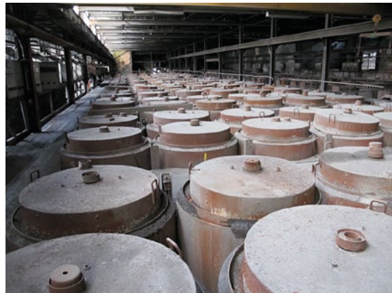
De mer enn 300 bevarte ovnene av Frank-Caro-type i Cyanamiden er et unikt særtrekk ved Odda Smelteverk. Foto: Trond Taugbøl.
