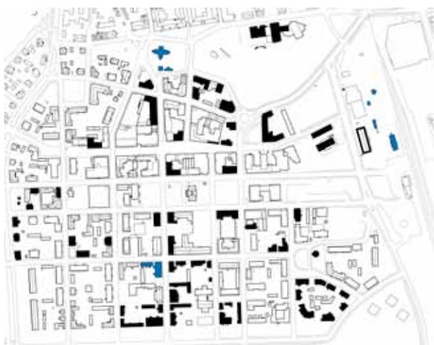
Byggnader i Jakobstads centrum som är skyddade genom detaljplan (svart markering) och på basen av separat lag eller statsrådsbeslut (blått).
