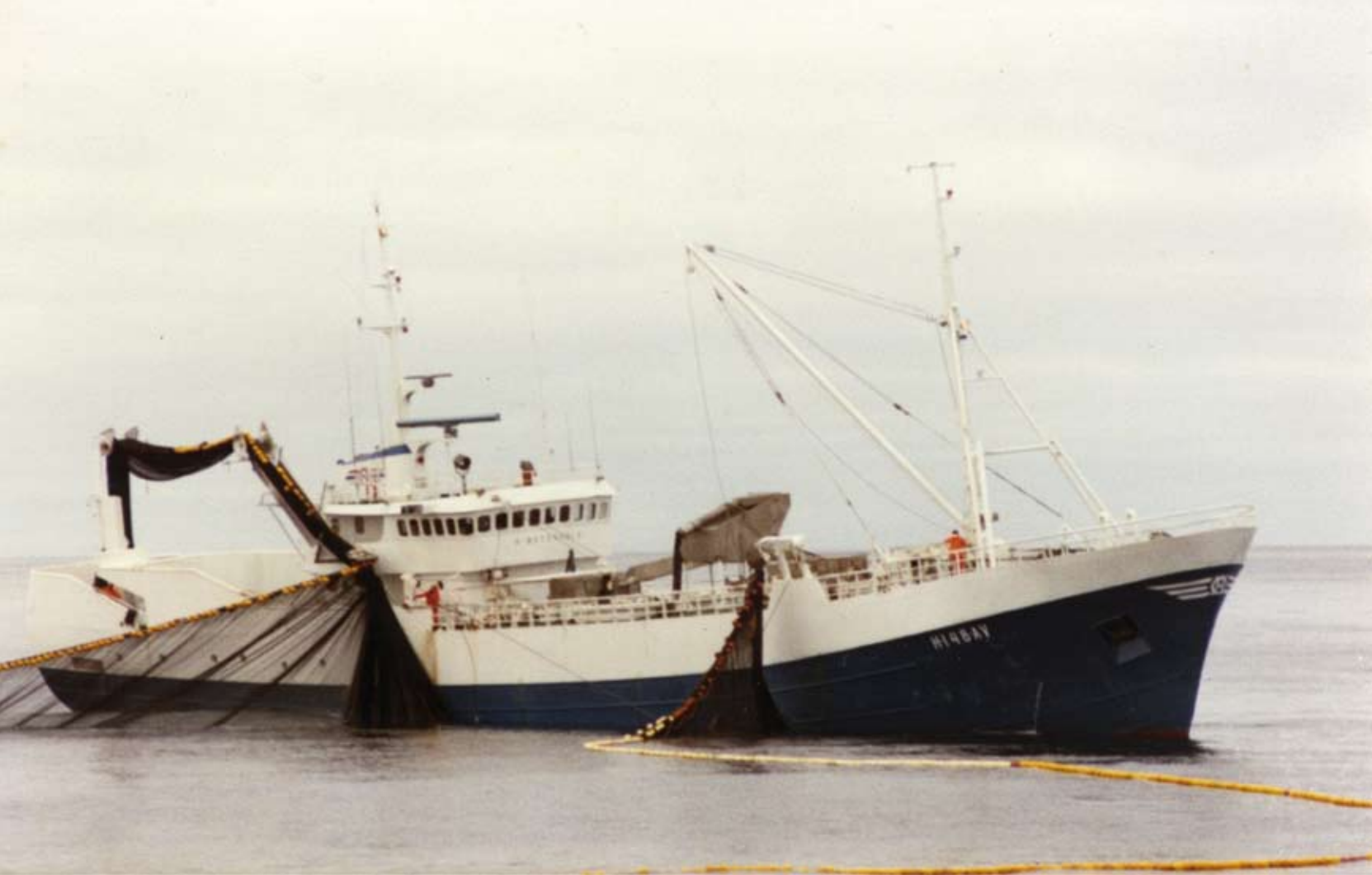
Ringnotsnurperen haler inn den enorme ringnota med kraftblokken. Fra 1960-årene ble de fleste fangstene av sild, makrell, lodde og kolmule tatt med slike høyeffektive havfiskebåter. Foto: Norges Fiskerimuseum
