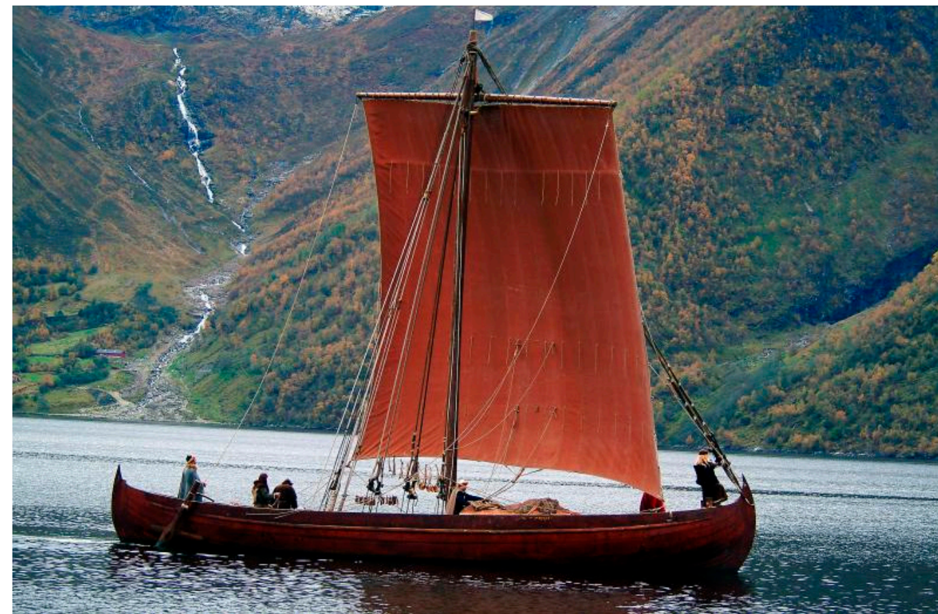
Det såkalte Skuldelev 1-skipet fra første halvdel av 1000-tallet som er funnet i Roskilde-fjorden, antas å være et lasteskip av den typen som ble kalt knarr. Det har vært 16 meter langt og 5 meter bredt. Fotografiet viser Borgund-knarren, en rekonstruksjon i full størrelse som ble bygd i 1993 av båtbygger Jacob Bjarkedal, Volda, og tilhører Sunnmøre Museum. Foto BBC / Sunnmøre Museum.
