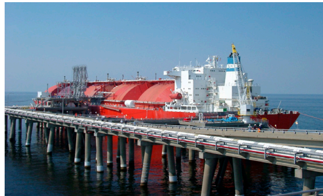
Gasstankeren Norman Lady, som her ses ved terminal i USA, ble levert fra Rosenberg Verft i 1973 og tilhører Høegh LNG AS. Høegh-rederiet har deltatt aktivt i utviklingen av skip for transport av flytende naturgass (LNG). Norman Lady på nær 51 000 tonn dødvekt var verdens første LNG-skip med kuletanker, og prototypen for "Moss spherical cargo containment system". Fordelen ved kuleformen er at den øker tankenes evne til å motstå høyt trykk og reduserer behovet for nedkjøling av gassen. NLG-transport er teknologisk krevende. Nest etter offshore-skip er gasstankere i forhold til størrelsen den mest kostbare skipstypen i moderne norsk og internasjonal skipsfart. Foto Høegh LNG AS.
