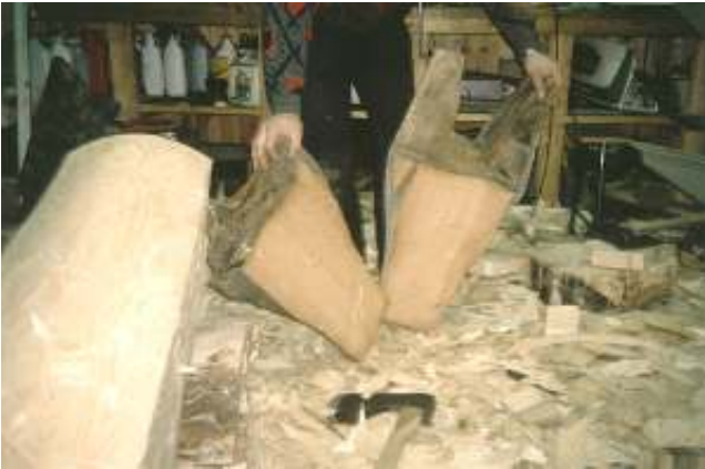
Den råtne delen av stubben ble hogd bort, ny del plugget til den gamle Foto: Hans Marumsrud 1993.
