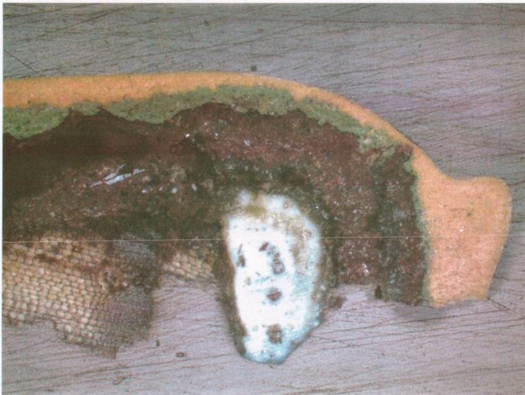
Fig. 22: Tverrsnitt av malinglag på porten i vindemark på sørfasaden. Foto: NIKU, B. Wedvik 2006
