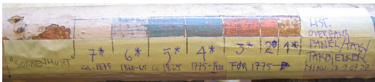
Figur 18. Røros. "Løbør-an", "Sorkenhuset". Farge-trapp på 1700- talls halvstaffs list som har stått i overgangen mellom taklist/stussbrett og veggpanel. * = Avsluttende malingslag. Foto: Brønne. 13.9.2007.
