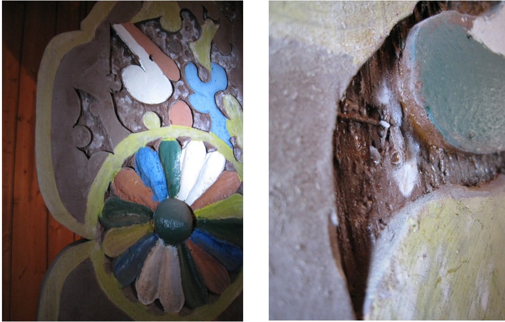
Figur 17 Korpus, venstre side. Det hvite belegget/muggen sees tydelig i øvre del av bildet. Foto: NIKU
