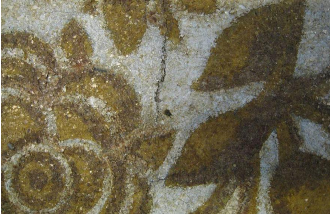
Figur 18. Bildet viser de små glassflakene. De er glassklare, men ser farget ut pga den omkringliggende malingens farge. Foto: NIKU 2009.
