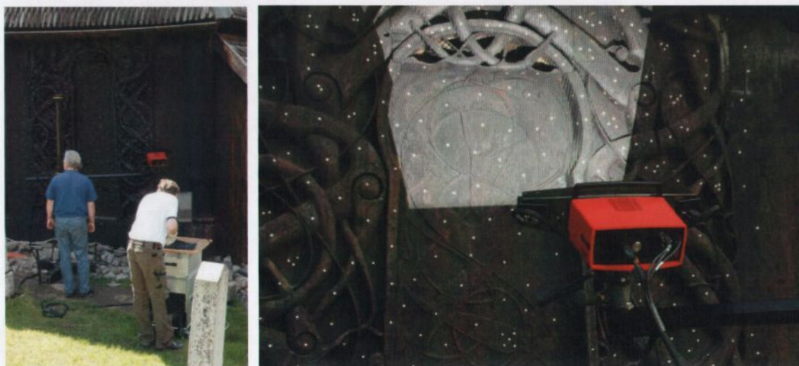
Figur 2 – Bruk av ATOS GOM III fotoskanner til detaljiskanning av nordportalen. Foto: Knut Paasche, NIKU
