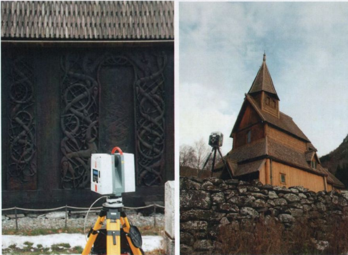
Figur 1 - Leica HDS6000 fasebasert laserskanner (til venstre) og Trimble GS200 pulsbasert laserskanner (til høyre). Foto: Knut Paasche, NIKU
