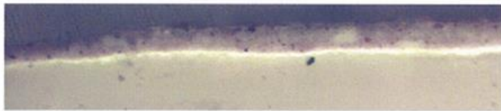
Figur 3. Makrofotografi af udsnit af tværsnittet af prøve P3b optaget under UV-fluorescens belysning. På bildet ses det tydeligt hvordan det upigmenterede isoleringslag mellom grundering og malelag ligger som en sterkt fluorescerende linje mellom de mindre fluorescerende grunderings og malelag. Der ses dog ikke nogen tegn på nogen form for fluorescerende lag ovenpå malelaget.
