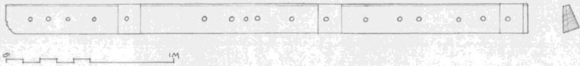
Utskiftet del av festebjelken på nordsiden. Skissemessig oppmåling OS 08
