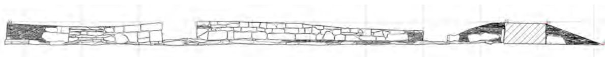
Figur 205: Ytterlivet av M2. Muren er brutt av døråpningene inn til rom 9 og 10. Partiet med mindre kleberkvadere mellom døråpningene er trolig rekonstruert (Illustrasjon: Marcin Gladki 2008).
