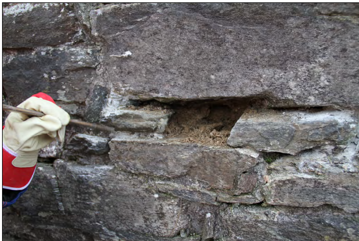
Figur 23: Mørtelprøve 3 ble tatt fra vestmuren i dagrommet (rom 7). Ved å fjerne harde sementfuger i murlivet ble det mulig å ta ut en stein som antageligvis stod in situ , og hente ut opprinnelig middelaldermørtel (foto: Byantikvaren 2011).
