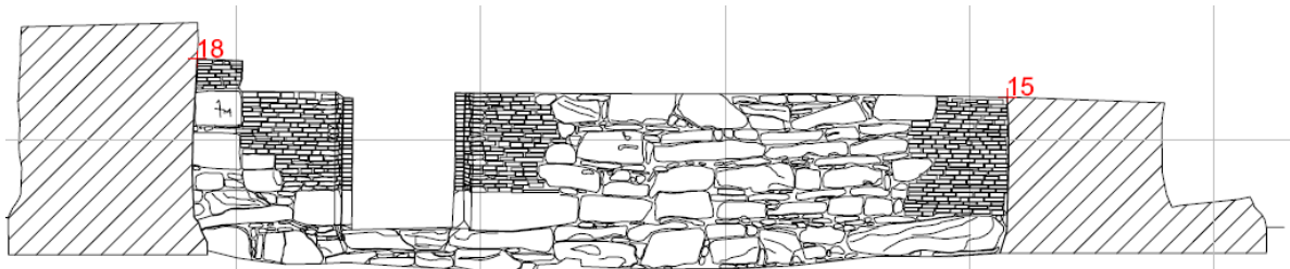
Figur 149. Oppmåling av indre murliv i nordmuren i dagrommet (Illustrasjon: Marcin Gladki, 2008).
