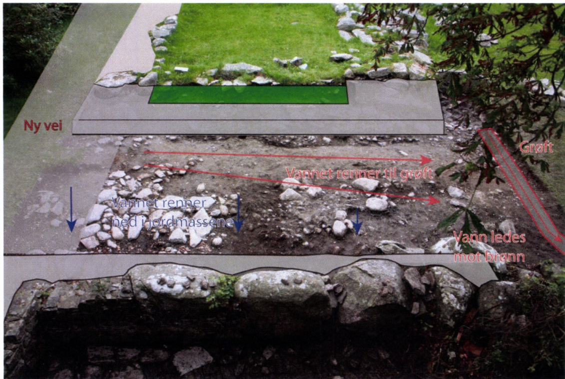
Fig.35 Illustrasjon av hvordan regnvannet renner og forslag til plassering av infiltrasjonsgrøft.
