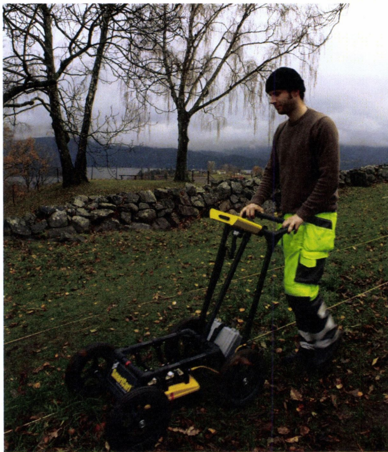
Fig.15 Eksempel på georadarundersøkelse, foto fra Holla kirkeruin 28.10.11.
