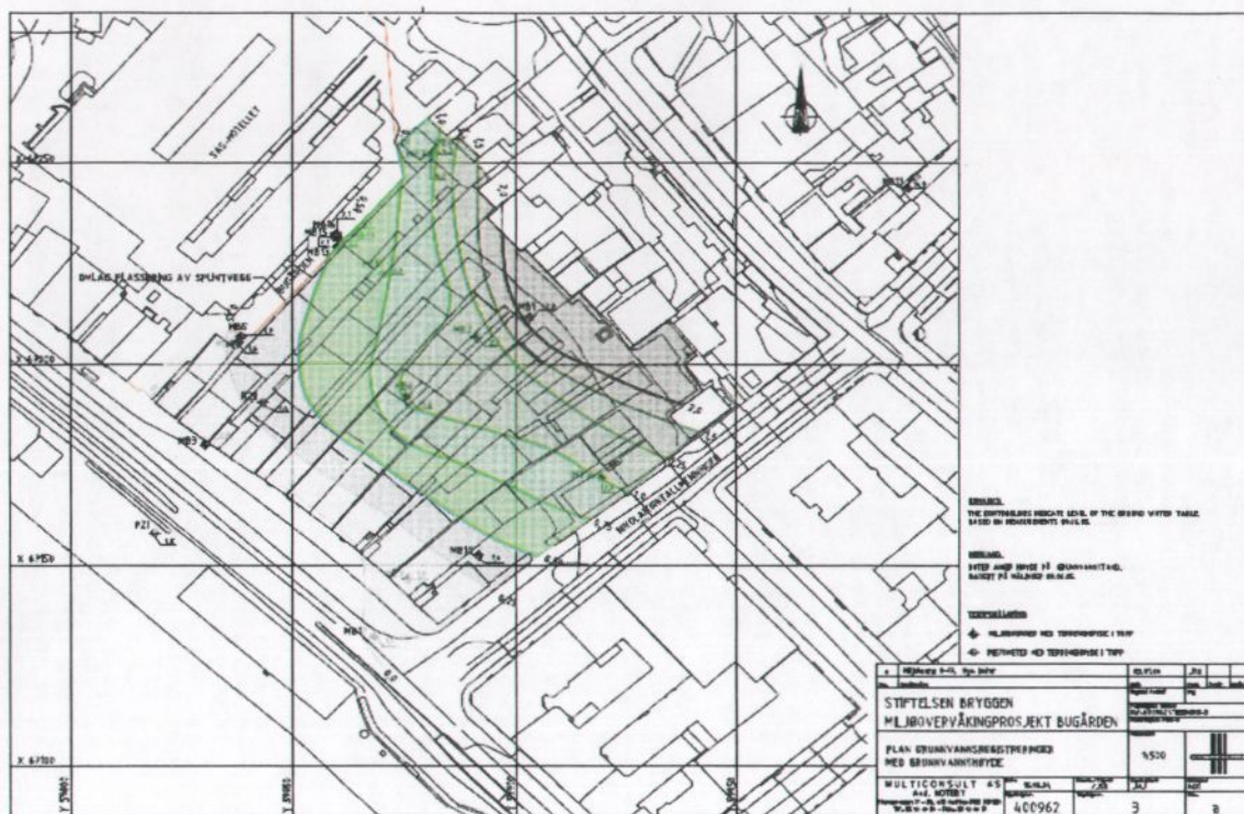
Figur 7: Viser grunnvannshøydene (koter) på Bryggen i 2005. Høyder fra 0 til 3 m. Kilde: Multiconsult AS rapport nr 610694-1, datert 22.12.05.
