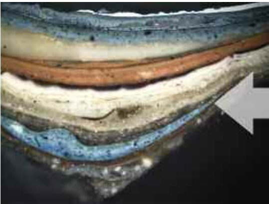
Tverrsnittbilder av materialprøver viser den opprinnelige fargesettingen med sølv i den første perioden.
